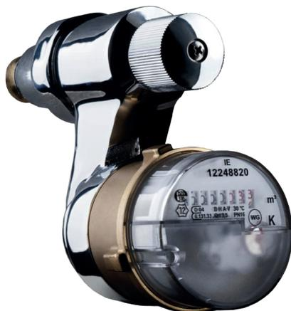
Il contatore con rubinetto e supporto (cromati) VTZ, è studiato per contabilizzare il consumo d'acqua di una singola mandata. È del tipo a quadrante asciutto orientabile a trasmissione magnetica (Super Dry a 8 rulli).
