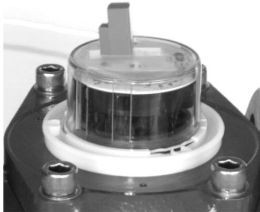
Emettitore di impulsi tipo "reed-switch" per contatori a mulinello Woltmann .
