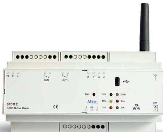
Il dispositivo STCM2 "Concentratore per dispositivi M-Bus" è un master che ha lo scopo di raccogliere i dati da una rete di dispositivi M-Bus e inviarli ad un centro di contabilizzazione remota tramite il modem GSM-GPRS interno.
