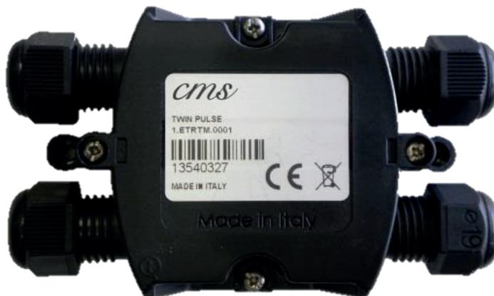
Contaimpulsu per applicazioni metering in configurazione slave su linea M-Bus in grado di acquisire fino a 2 ingressi impulsi (reed switch, contatti puliti – open collector).
